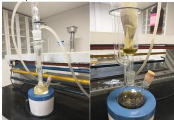
Figura 3: Extração da Casca e Coroa do Abacaxi no Extrator de Soxhlet.
