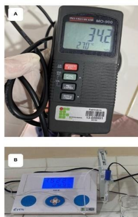
Figura 4. A: Aparelho para medir a temperatura da água, B: Aparelho para medir o pH da água.
