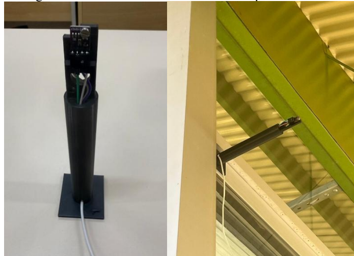
Figura 13. Sensor BME280 alocado em suporte instalado.
