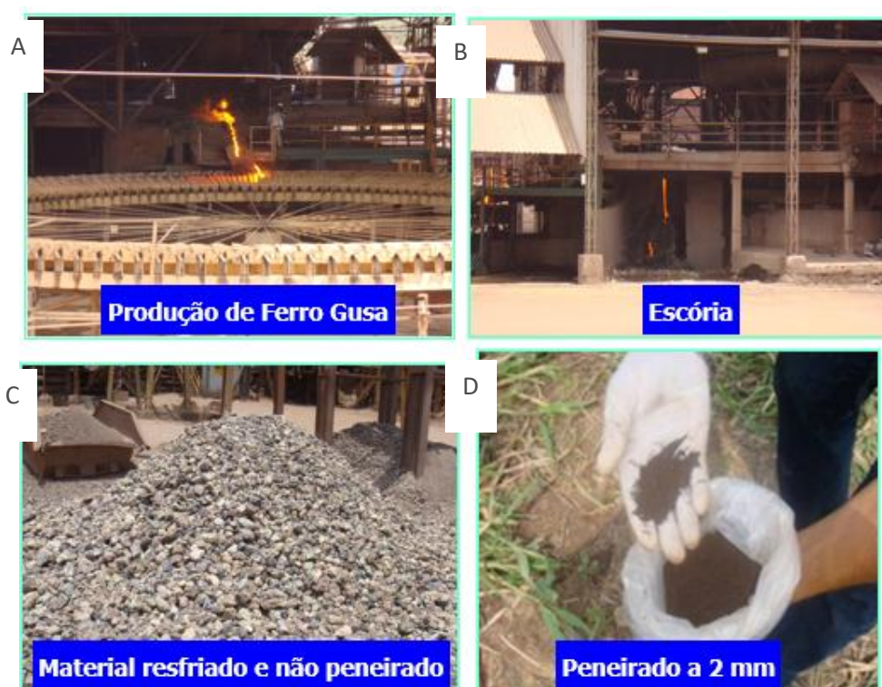
Figura 1. Aspecto geral do processamento de minério de ferro a ferro gusa (A), vazamento de escória como resíduo (B), resfriamento do resíduo (C) e apresentação da escória britada e peneirada (D), oriunda de siderúrgica da região de Marabá / PA
