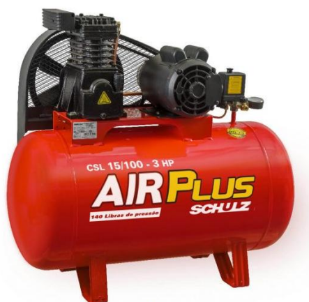
Figura 3: Compressor a pistão com reservatório e motor elétrico.
