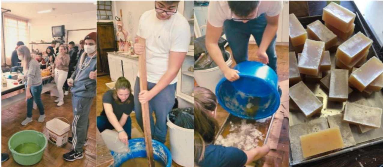
Figura 20: Processo de produção do sabão de álcool, com as etapas envolvidas na reação de saponificação e na formação do produto final.
