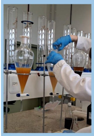
Figura 17: Transferência do óleo para o funil de decantação.
