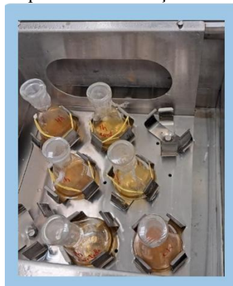
Figura 9: Amostras durante o período de incubação em banho termostatizado a 35°C.
