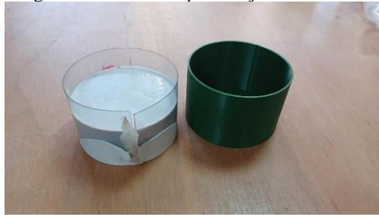
O insumo que utiliza para montar a peça que simula o queijo é o Silicone Bicomponente na cor branca, que traz a textura e peso equivalentes à peça original (*fig. 5*).
