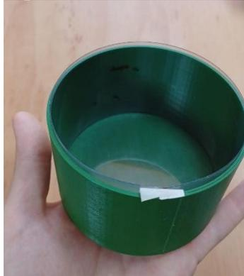
Dentro deste molde coloca um acetato para desenformar corretamente o produto a ser derramado (fig. 4).
