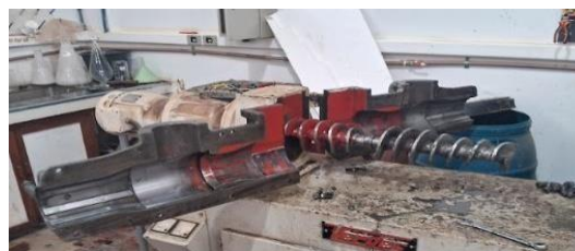
Figura 2 - Equipamento extrusor, aberto, em bancada, UFLA, PPGMAT.
