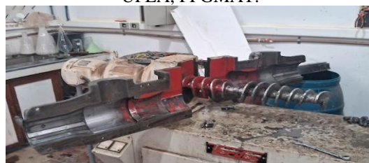
Figura 2 Equipamento extrusor, aberto, em bancada, UFLA, PPGMAT.
