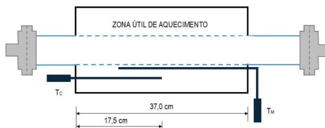
Fig.3 – Esquema do posicionamento dos termopares de controle (TC) e de medida (TM).
