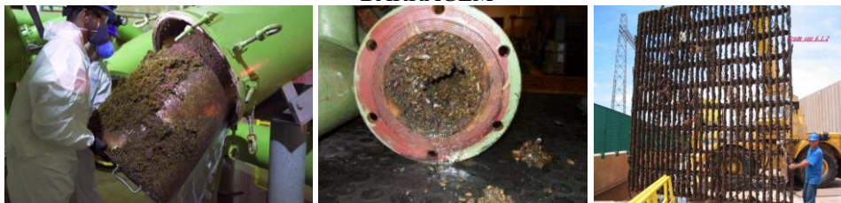
FIGURA1 COLMATAÇÃO DE ELEMENTOS DE MAQUINAS GERADORAS DE ENERGIA ELÉTRICA EM BARRAGEM
