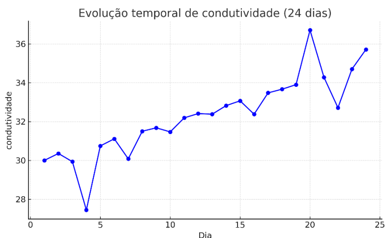
Figura 8. Evolução da condutividade elétrica ao longo do cultivo, com tendência crescente associada à evaporação e acúmulo de sais dissolvidos.
