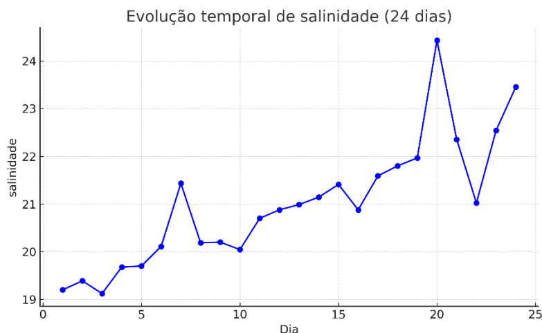
Figura 10 - Variação temporal da salinidade, com aumento progressivo e picos pontuais, indicativos de acúmulo iônico e maturação do sistema.
