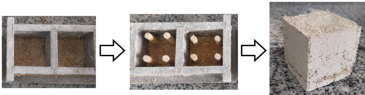
Figura 2 - Posicionamento dos suportes durante a fabricação dos corpos de prova.
