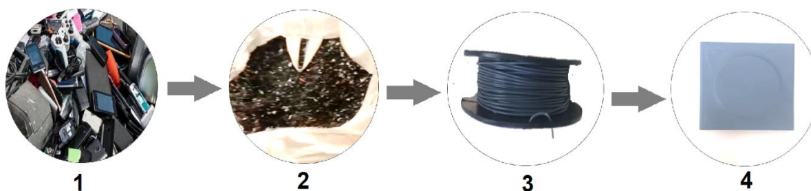
Figura 2: Etapas para obtenção do piso tátil.
