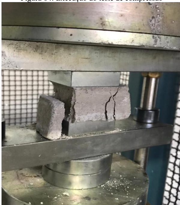
Figura 04: Execução do teste de compressão
