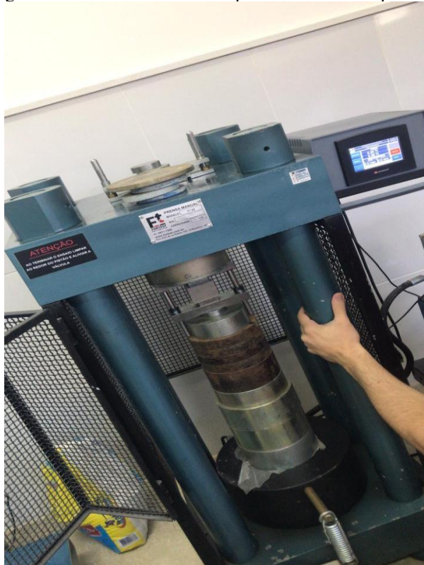
Figura 03: Prensa manual usada para o teste de compressão.
