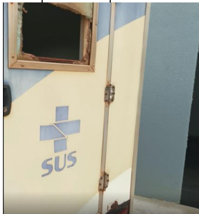
Figura 8. Vidro da porta do compartimento traseiro quebrado.
