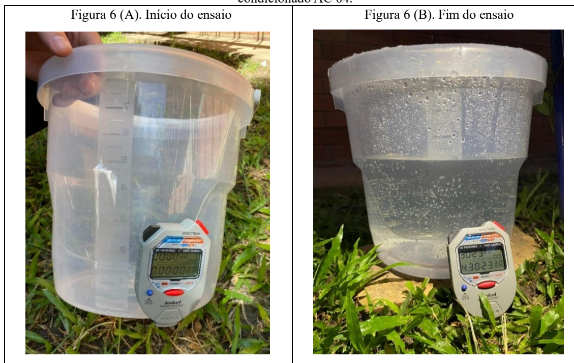
Figura 6. Ensaio experimental para determinação da taxa de produção de água condensada do aparelho de ar-condicionado AC 04.
