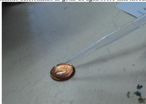
Figura 4. Estudantes adicionando as gotas de água sobre uma moeda de 5 centavos.
