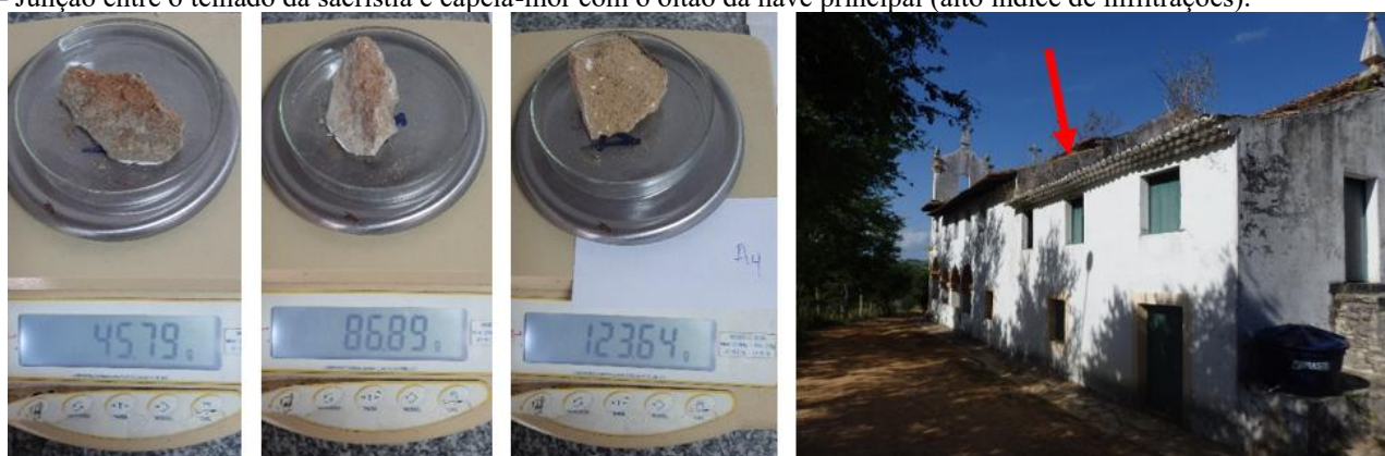
Figura 16: (as duas à esquerda) – Amostras A2 PU e PS + placa de petri. (centro) - Amostra A4 PS + placa de petri. (direita) – Junção entre o telhado da sacristia e capela-mor com o oitão da nave principal (alto índice de infiltrações).
