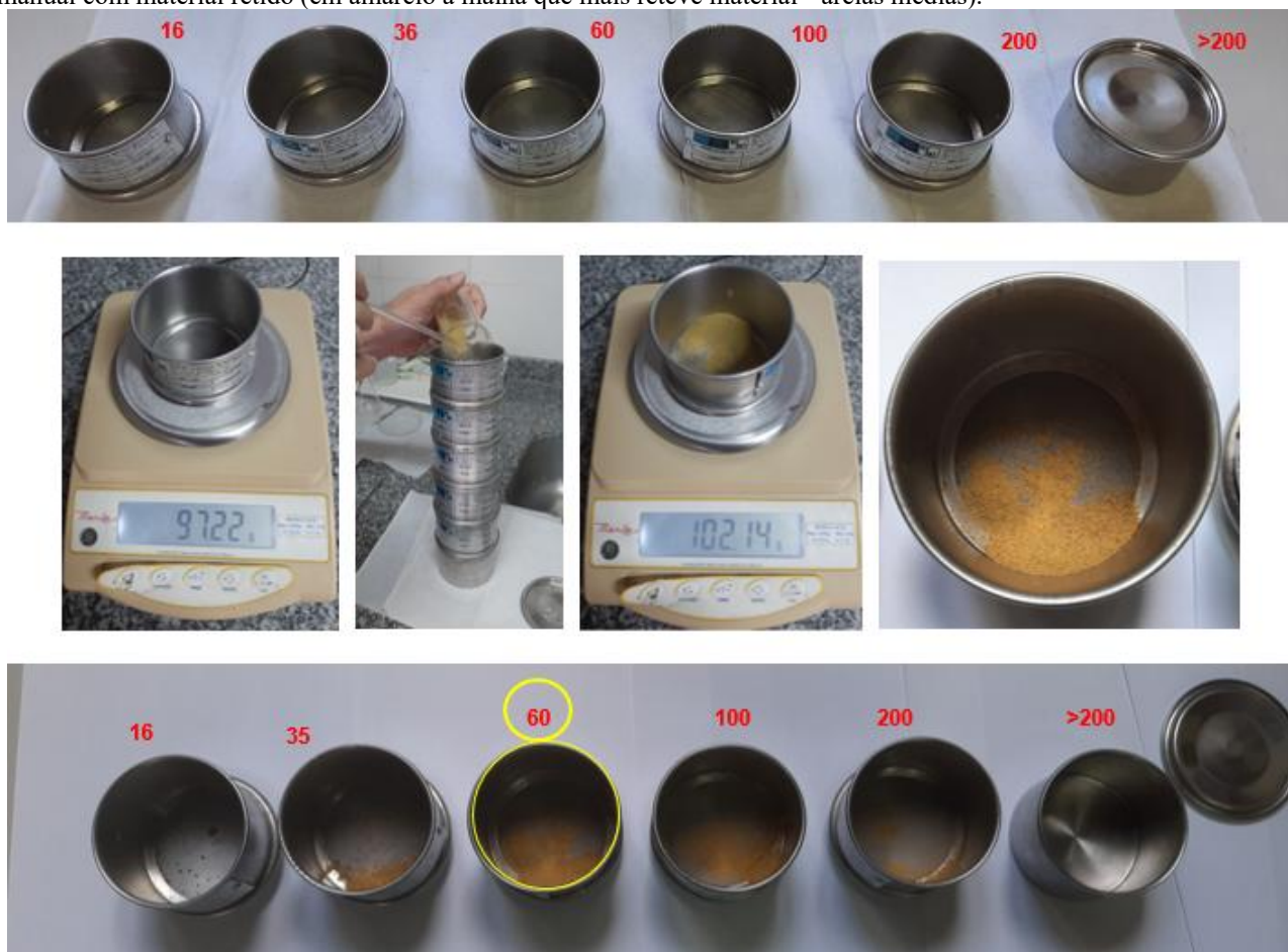
Figura 19: (acima) – Peneiras de malhas 16; 35; 60; 100; 200 e >200. (centro da esquerda para a direita) - Peneira malha 35. Colocação dos grossos do béquer para a agitação manual por 5 minutos. Pesagem peneira 60 + material retido. Peneira 60 com material retido (o de maior peso retido). (abaixo) – Peneiras de malhas 16; 35; 60; 100; 200 e >200 após agitação manual com material retido (em amarelo a malha que mais reteve material - areias médias).
