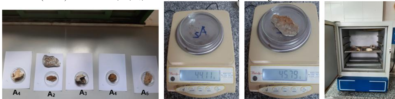
Figura 14: (esquerda) - Preparação das amostras para observação visual e análise de umidade. (centro) – Pesagem da amostra A 2 . (direita) – Amostras A 1 , A 2 , A 3 , A 4 e A 5 colocadas na estufa para secagem.
