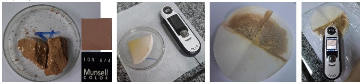
Figura 20: (da esquerda para a direita) – Torrões da amostra A4 analisados pelo processo MUNSELL obtendo a cor 10R 6/4 . Papel de filtro com os finos (argila e ou silte) e colorímetro digital RM200 NCS (Natural Color System). Papel de filtro com resíduo dos finos, amostra A4 . Aferição da cor dos finos pelo processo NCS identificando a cor dos finos como S4010-Y10R .
