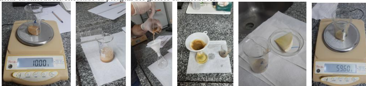
Figura 18: (da esquerda para direita) – Pesagem da Amostra A4 após ser destorroada para ensaio do traço. Ataque com adido clorídrico para separação dos grossos dos finos (digestão). Filtragem da Amostra A4 após ataque ácido. Resultado da separação dos grossos dos finos da amostra A4. Grossos (béquer) e finos (papel de filtro) após secagem na estufa por 24 horas da amostra A4. Resultado da pesagem dos grossos da amostra A4.
