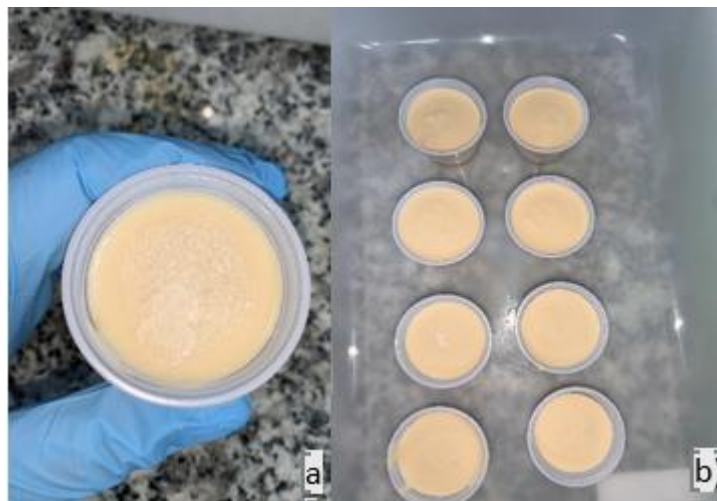
Figura 10: Teste de resistência a exposição a luz. a) amostra com placas maiores (óleo 15 dias) b) amostra com pontos (óleo 30 dias).
