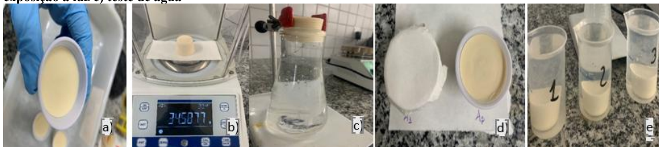
Figura 06: Parâmetros o sabão sustentável a) organoléptico b) peso médio e perda de massa c) rachaduras d) exposição a luz e) teste de água
