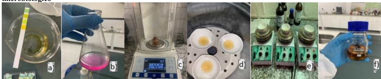
Figura 05: Parâmetros do óleo vegetal residual a) pH b) acidez c) densidade d) umidade e) impurezas f) microbiológico
