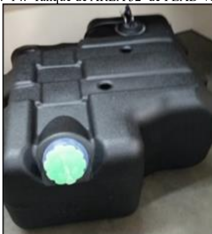
Fig. 14. Tanque de ARLA 32 de PEAD Verde.
