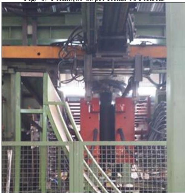
Fig. 8. Formação da pré forma ou Parison.
