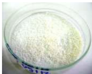
(a) Encapsulado de PCM de palmitato de cetila, após secagem em estufa com formação de pó
