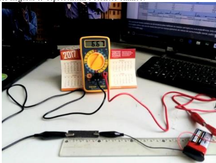
Fig. 6 – Circuito elétrico da primeira atividade: Bateria, amperímetro e resistor em série. As nossas fitas, com diferentes comprimentos L e diferentes larguras W representam o resistor ôhmico.
