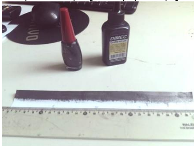
Fig. 2 – Uma das fitas de cartolina pintadas com lápis e grafite em pó que foi empregada como resistor nas atividades.
