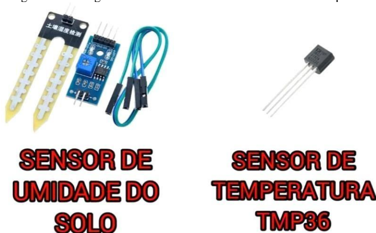
Imagem 5 - A imagem mostra o sensor de umidade do solo e temperatura
