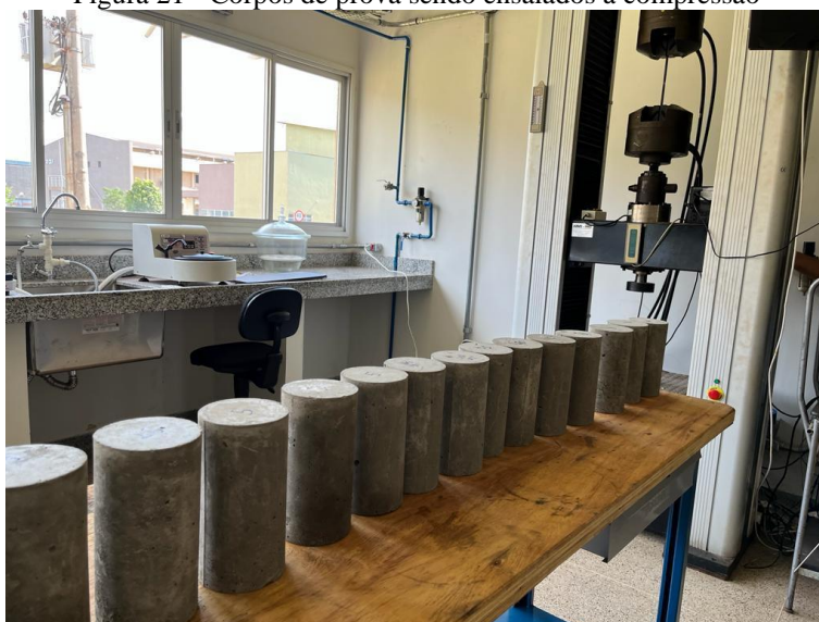
Figura 21 - Corpos de prova sendo ensaiados à compressão
