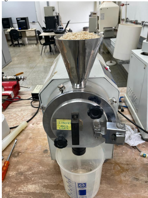
Figura 10 - Escamas sendo moídas em moinho de facas
