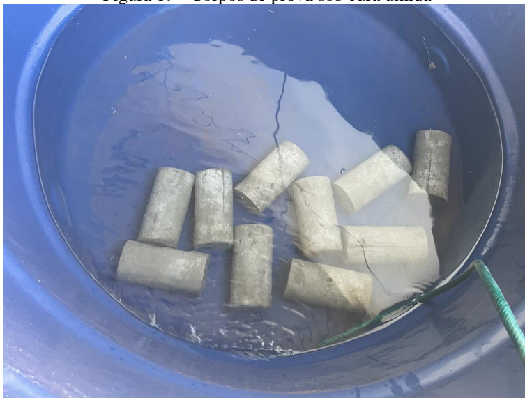
Figura 19 - Corpos de prova sob cura úmida
