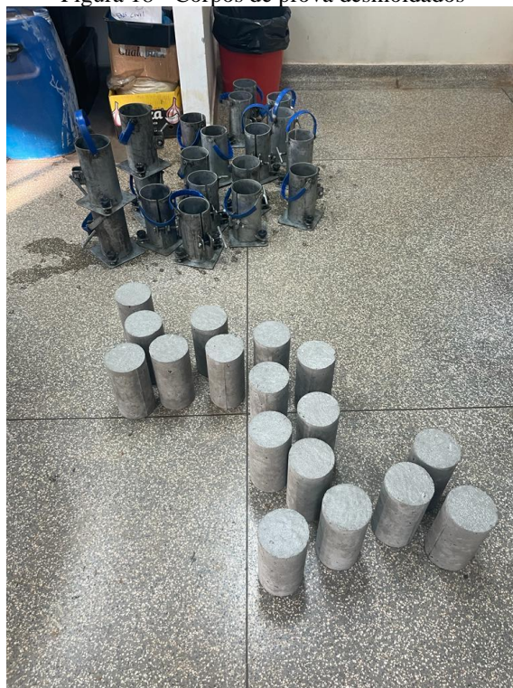
Figura 18 - Corpos de prova desmoldados
