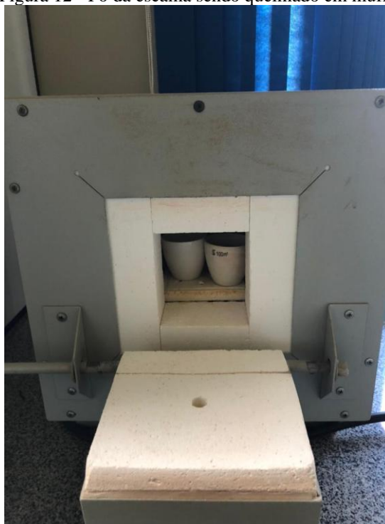
Figura 12 - Pó da escama sendo queimado em mufla
