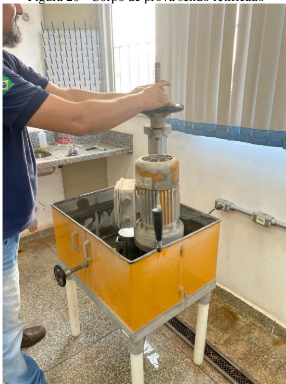
Figura 20 - Corpo de prova sendo retificado
