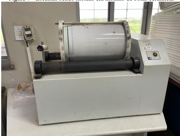
Figura 7 - Escamas sendo moídas em moinho de bolas cerâmicas
