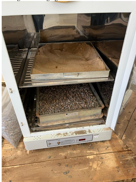
Figura 14 - Agregados sendo secos em estufa
