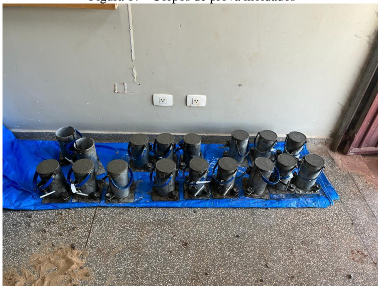
Figura 17 - Corpos de prova moldados
