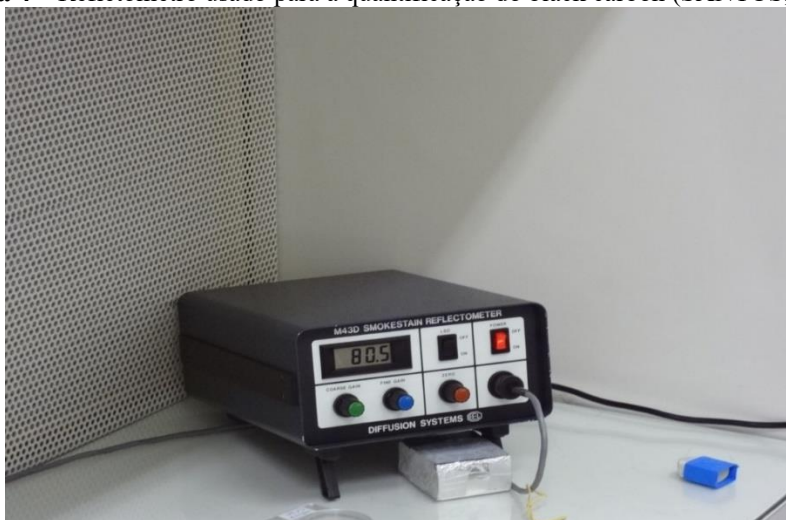
Figura 4 – Refletômetro usado para a quantificação do black carbon (SANTOS, 2014).
