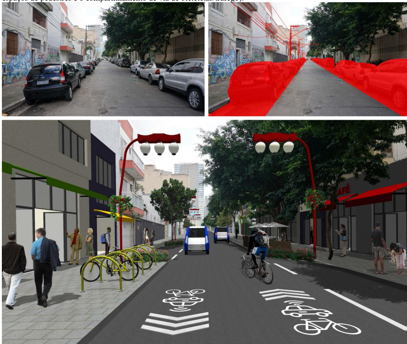
Figura 10 - Ilustração da proposta de desenho para a Rua Mituto Mizumoto (em cima à esquerda: estado atual; em cima à direita: elementos a alterar; em baixo: alterações propostas, a eliminação do estacionamento na rua, o alargamento dos espaços de pedestres e o compartilhamento de via de bicicletas/tráfego).
