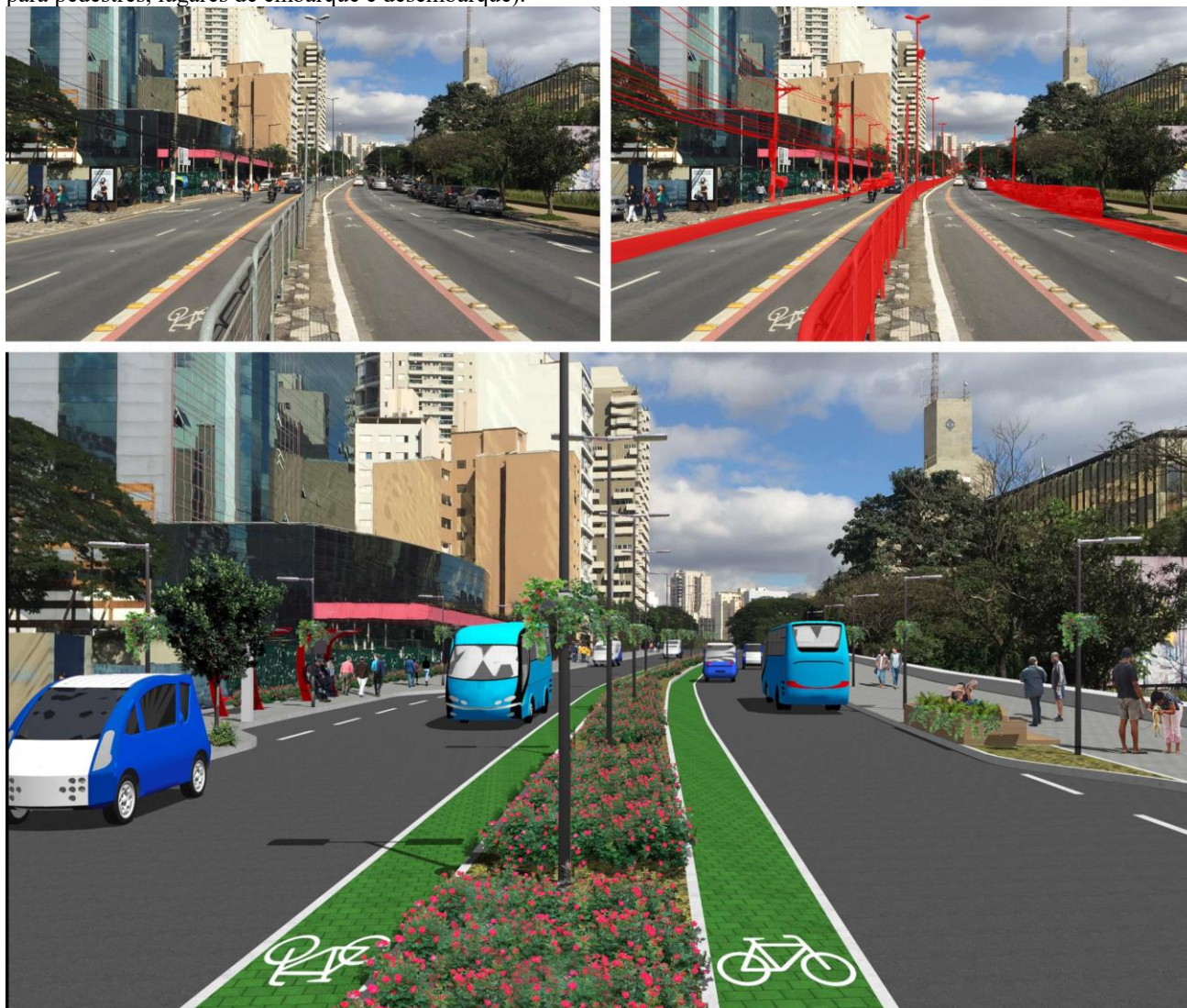
Figura 7 - Ilustração da proposta de desenho para a Rua Vergueiro (em cima à esquerda: estado atual; em cima à direita: elementos a alterar; em baixo: alterações propostas, eliminação do estacionamento na via pública, alargamento dos espaços para pedestres, lugares de embarque e desembarque).
