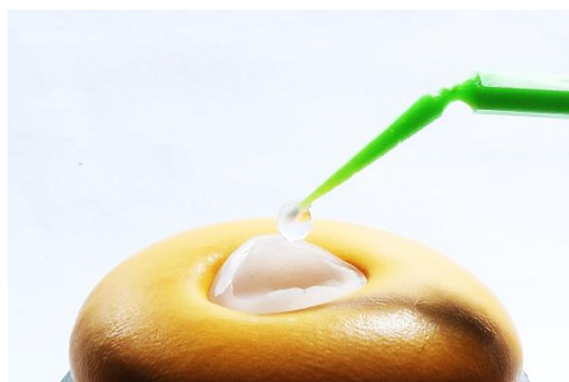
Fig. 29. Aplicação do agente de união silano na face interna da peça deixando evaporar por 60 segundos. Fonte: Próprio autor.
