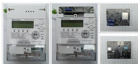
Figura 01: Medidores de wasion: À esquerda está o medidor completo, no centro está a parte superior do microcontrolador STM32WBA, no canto superior direito está a frente do microcontrolador e no canto inferior direito está o microcontrolador traseiro.
