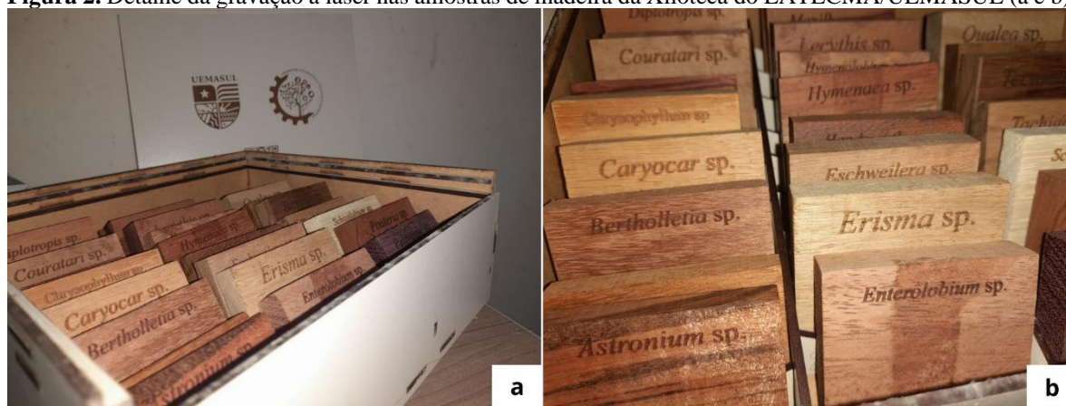
Figura 2. Detalhe da gravação a laser nas amostras de madeira da Xiloteca do LATECMA/UEMASUL (a e b).
