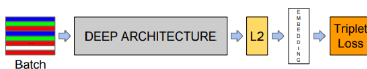
Figura 4 – Ilustração de funcionamento do modelo FaceNet
