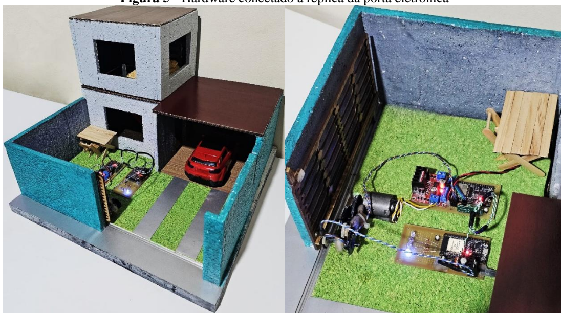
Figura 5 - Hardware conectado à réplica da porta eletrônica
