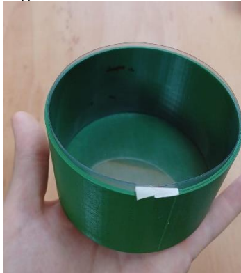
Fig. 3: Molde 3D com o acetato
