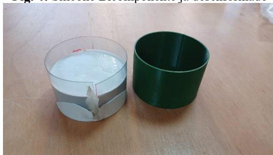
Fig. 4: Silicone Bicomponente já desenformado
