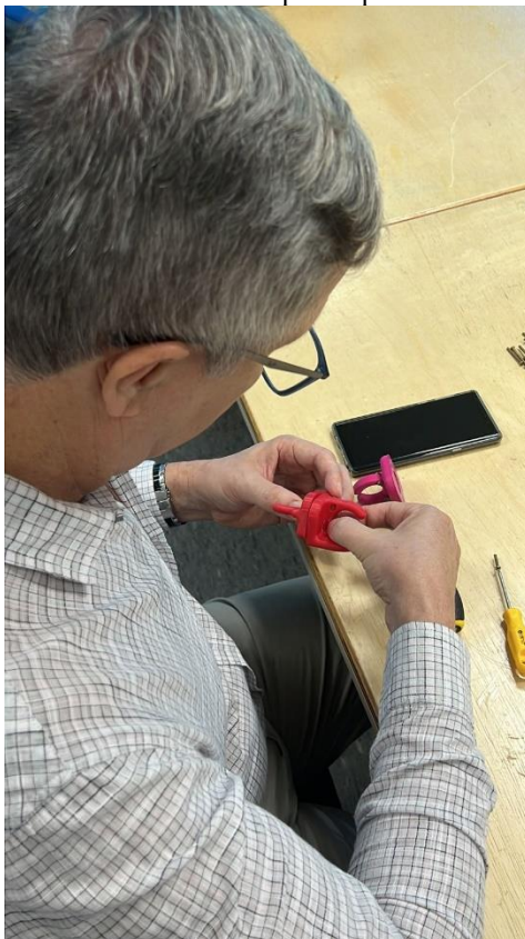
Fig. 13 – protótipo do suporte de moletas sendo montado após impressão em impressora 3D, do Laboratório Maker
