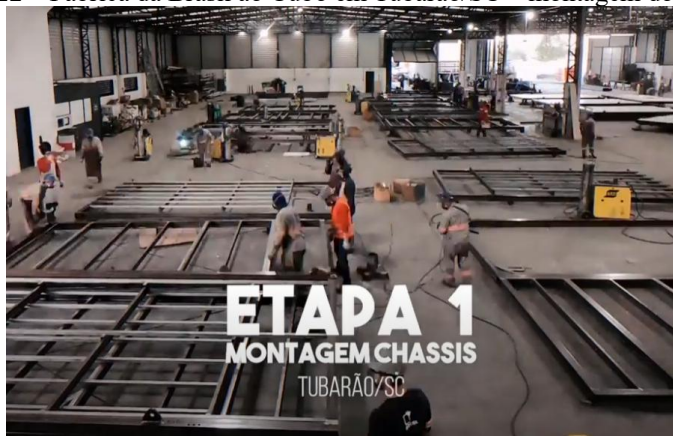
Figura 22 – Fábrica da Brasil ao Cubo em Tubarão/SC – montagem dos chassis
