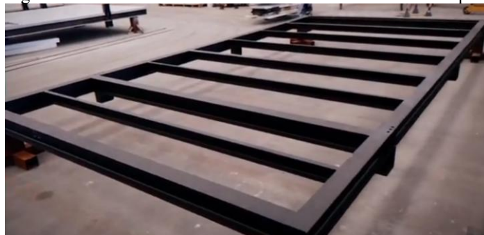
Figura 21 – Base do módulo em fábrica – chassi metálico de piso
