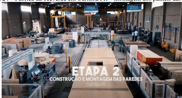
Figura 24 – Fábrica da Tecverde em Curitiba/PR – montagem dos painéis das paredes
