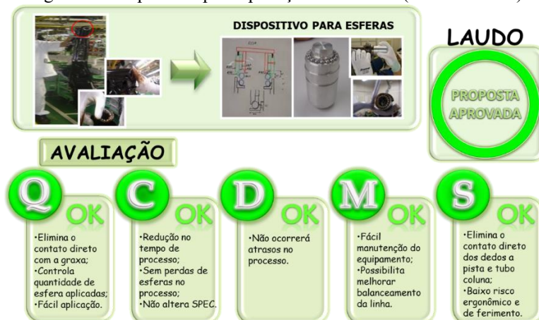
Figura 15: Dispositivo para aplicação das esferas (base imantada)
