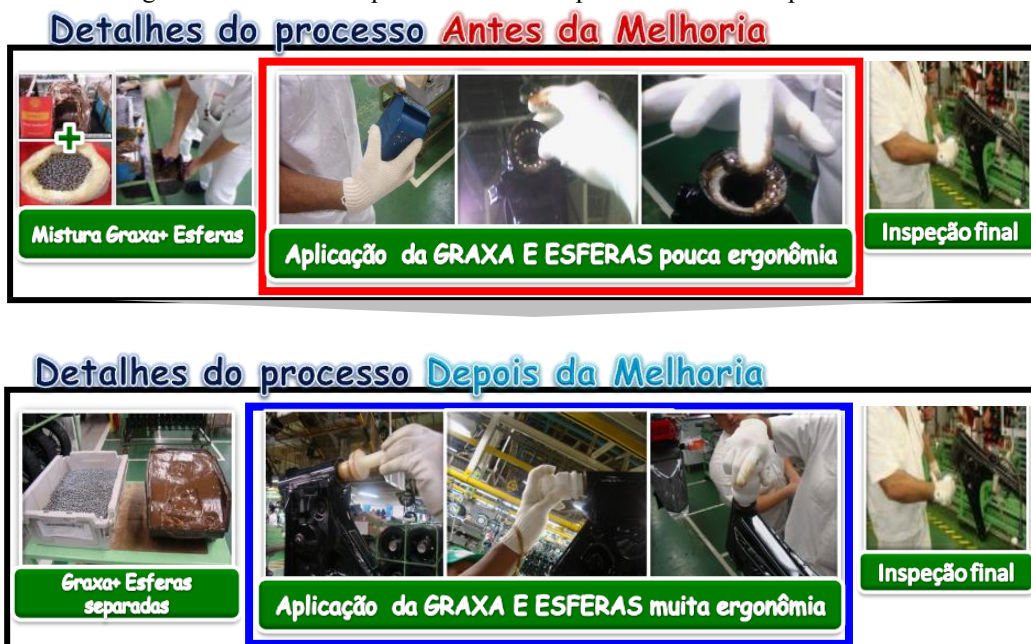
Figura 19: Detalhes do processo antes e depois da melhoria implementada
