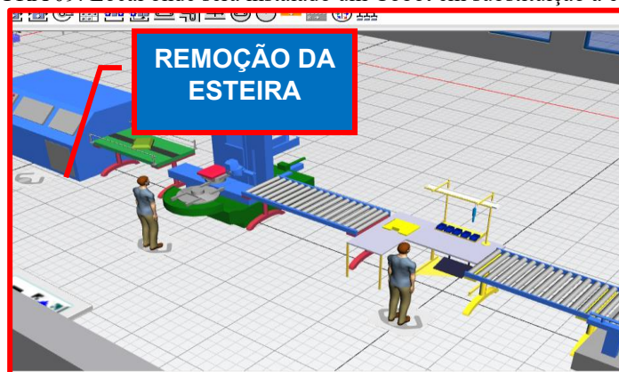
FIGURA 09: Local onde será instalado um Cobot em substituição a esteira.
