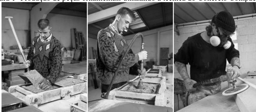
Figura 1- Produção de peças ornamentais utilizando a técnica do Concreto Compactado.
