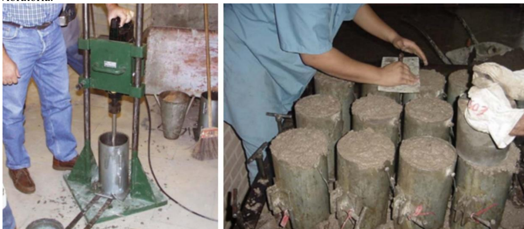
Figura 2. À esquerda: adensamento de corpo de prova com Martetele Tipo Kango; à direita: corpos de prova adensados em mesa vibratória.
