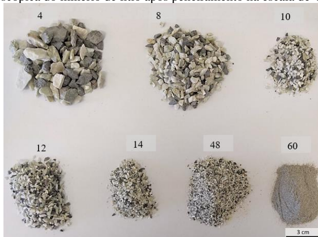
Figura 1: Visão macroscópica do minério de lítio após peneiramento na escala de 4# até 60# (serie Tyler).
