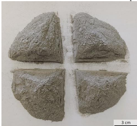
Figura 2: Quartejamento da amostra de minério de lítio na fração 60 # (serie Tyler).
