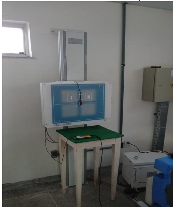
Figura 3 – Sensor de estado sólido e câmara de ionização Radcal® AccuGold®
