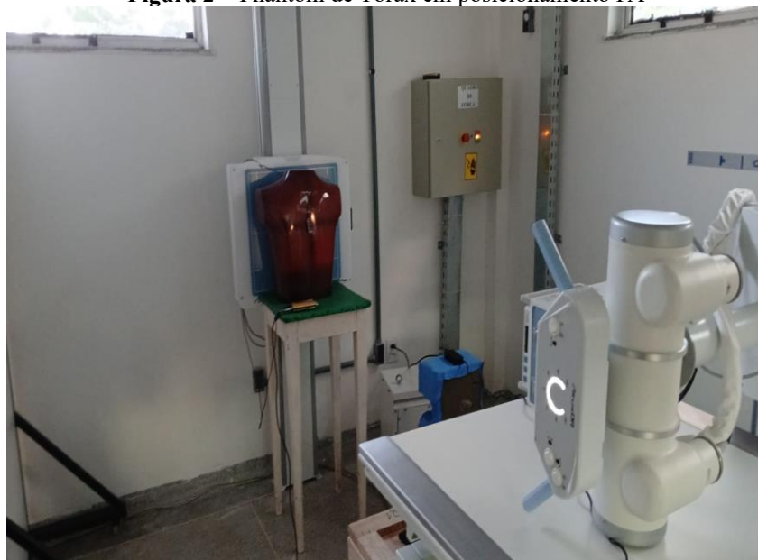
Figura 2 – Phantom de Tórax em posicionamento PA
