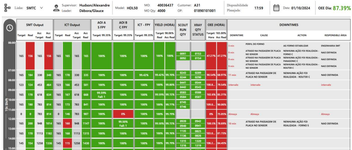
Figura 6 – Ambiente de “Gêmeo Digital” para a linha de montagem modelada (placas eletrônicas de notebooks e carregadores), em 1º de outubro de 2024.
