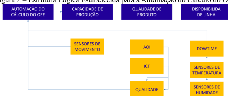
Figura 2 – Estrutura Lógica Estabelecida para a Automação do Cálculo do OEE.
