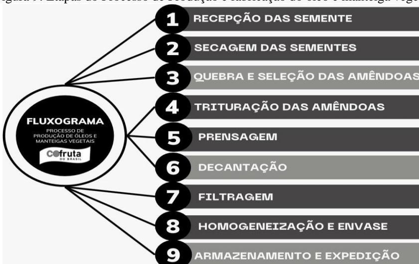
Figura 9: Etapas do Processo de Produção e fabricação do óleo e manteiga vegetais
