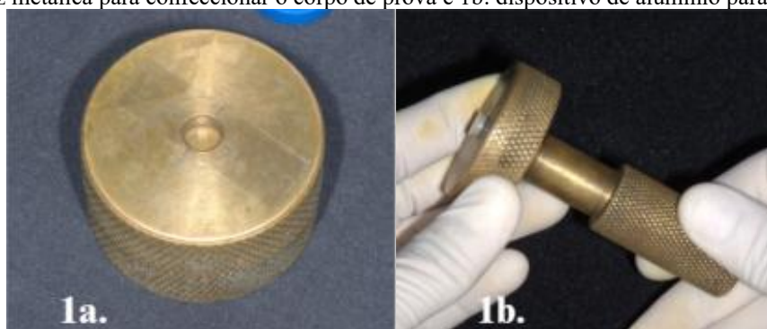
Figuras 1a: matriz metálica para confeccionar o corpo de prova e 1b: dispositivo de alumínio para remover a amostra
