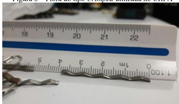
Figura 6 – Fibra do tipo Crimped utilizada no CRFA
