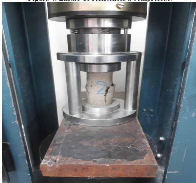
Figura 4. Ensaio de resistência à compressão.
