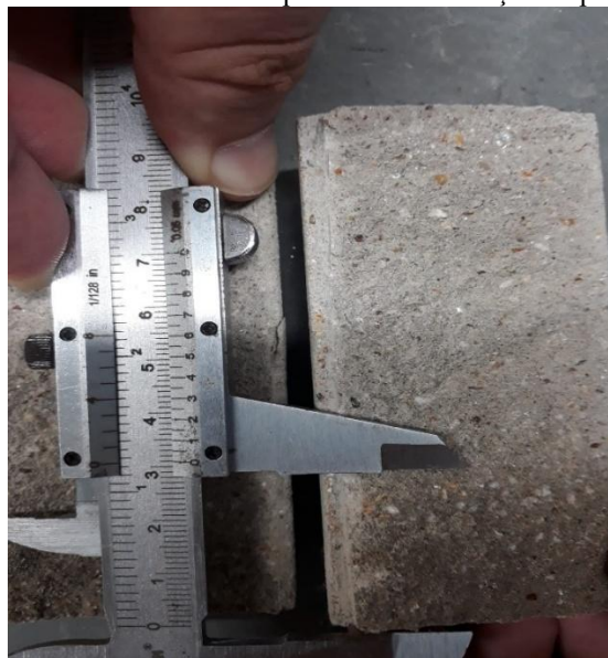
Figura 6. Leitura da ascensão capilar com a utilização de paquímetro.
