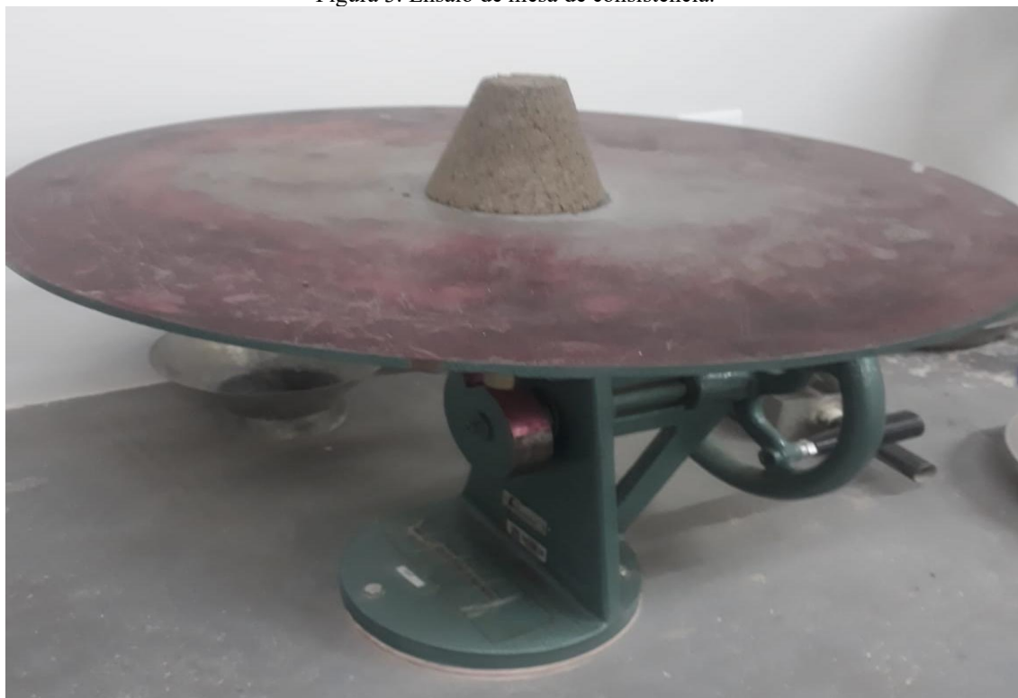
Figura 3. Ensaio de mesa de consistência.
