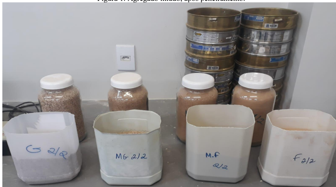
Figura 1. Agregado miúdo, após peneiramento.
