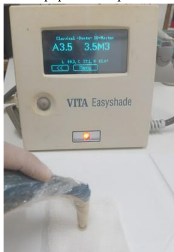
Figura 7 - Medição da cor dos corpos de prova utilizando espectrofotômetro digital (Easyshade – Vita, Brea, California, USA), onde a sonda do equipamento é posicionada rente a amostra.
