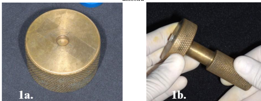
Figuras 1- a. matriz metálica para confeccionar o corpo de prova e b. dispositivo de alumínio para remover a amostra
