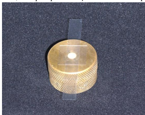
Figura 3: Lâminula de vidro de 1,2mm para padronização da distância da ponteira do fotopolimerizador
