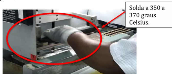
Figura 8. Processo de imersão dos transformadores no banho de solda.
