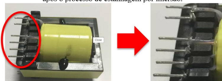
Figura 6. Análise comparativa da morfologia dos terminais: (A) Estado in natura pré-soldagem e (B) Interface metálica após o processo de estanhagem por imersão.
