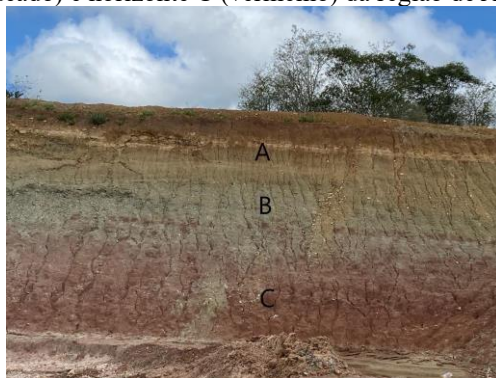
Figura 1: Local da extração do material estudado. Representação dos horizontes A (em amarelo), horizonte B (esverdeado) e horizonte C (vermelho) da região de Araripina
