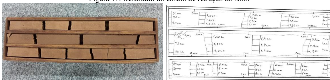
Figura 11: Resultado do ensaio de retração do solo.
