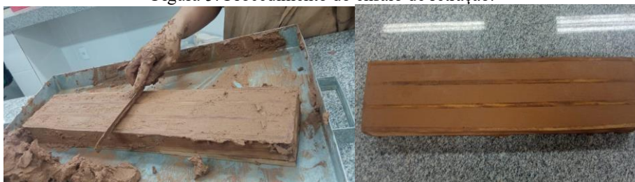
Figura 5: Procedimento do ensaio de retração.
