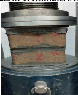
Figura 8: Ensaio de resistência à compressão.
