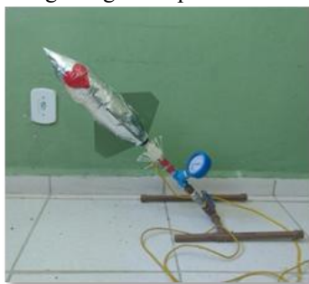
Figura 5: Foguete garrafa pet com sua base PVC.
