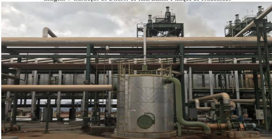
Imagem 4- Ilustração do Difusor de cana Zanini e tanque de condensado
