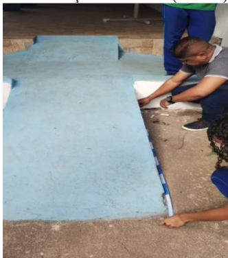
Figura 4 – Aferição da Rampa 2: medição da altura (28 cm) e do comprimento (145 cm).
